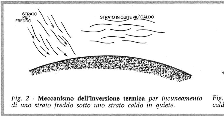
Fig. 2 - Meccanismo dell'inversione termica per incuneamento di uno strato freddo sotto uno strato caldo in quiete.
